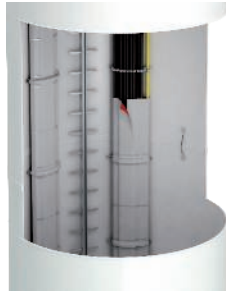
Vertikāla trase ar bandāžu vēja ģeneratora mastā
