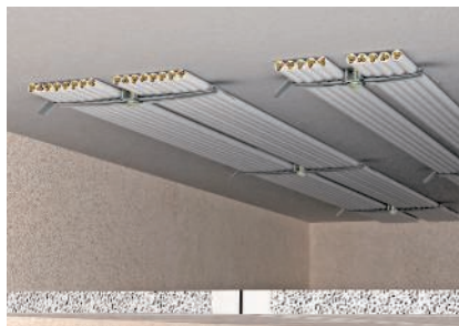
Griestu montāža virs iekārtajiem ugunsdrošības griestiem
