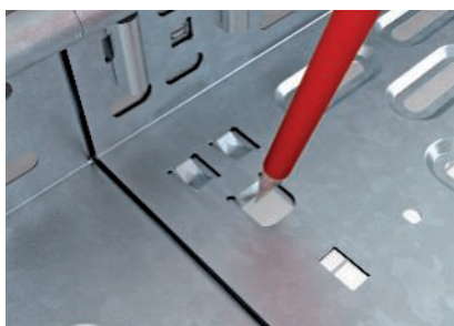
Salaidumu vietu savienošana bez skrūvēm, tikai jāaplic pie pamatnes mēlītes
