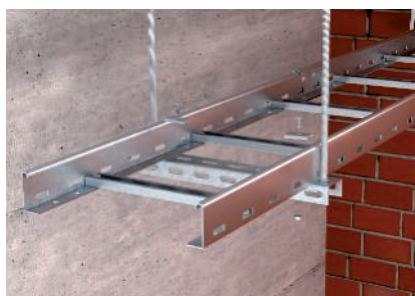
Montāža uz horizontālā profila ar fiksatoru, plakangalvas skrūvēm un lielizmēra paplāksnēm
