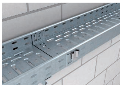
Sasprausts salaidumu vietas savienojums, tikai apliecot pamatnes mēlītes
