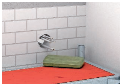
Minerālvate ar kušanas punktu \geq 1000 °C atveres aizpildīšanai
