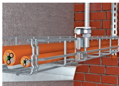
Pieslēguma elementa nostiprināšana uz sānu stieplēm bez skrūvēm
