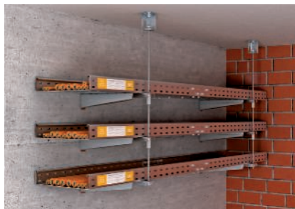
Montāža pie sienas vairākos līmeņos ar vertikālu vītņstieņa stiprinājumu
