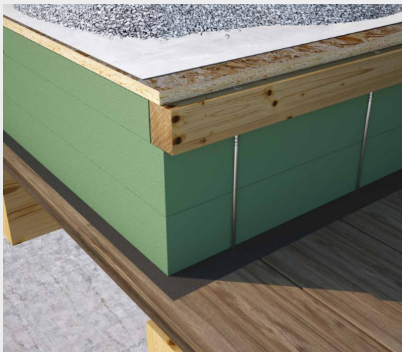
^ Cietās izolācijas stiprināšana uz plakana jumta.
