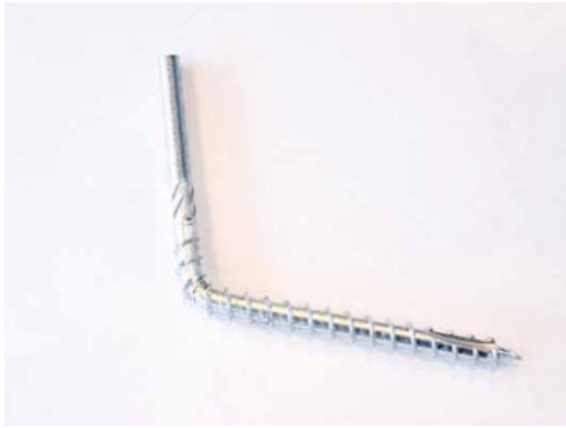
Cikliska testa beigās deformēta skrūve.
