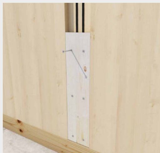
^ Sienas stiprinājumi CLT ar HBS skrūvēm 6 mm diametrā.
