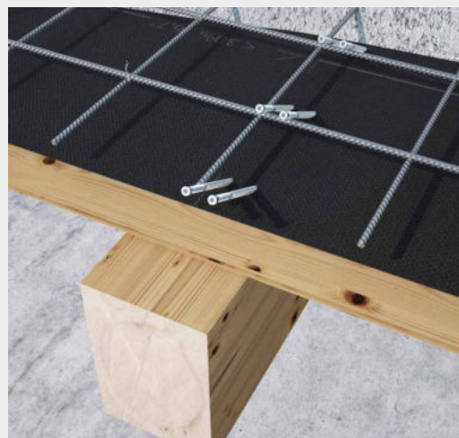
^ Koka-betona grīdas segums ar savienotāju izvietojumu 30° divās rindās.
