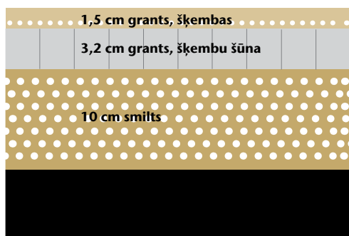
Gājēju un velosipēdiem vajadzīga 10 cm bieza smilts pamatne.
